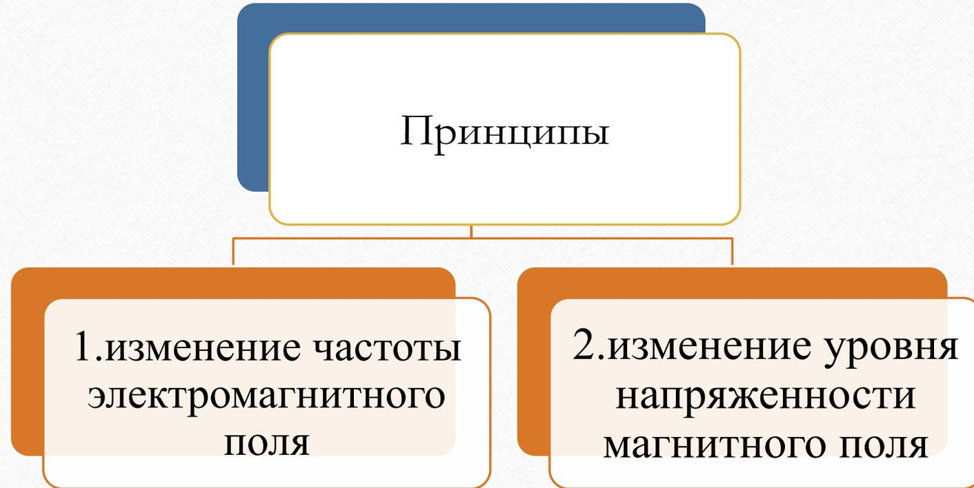
Работает синхрофазотрон по принципу циклического ускорителя. Чтобы гарантировать нахождение частицы на одной и той же равновесной орбите, частота ускоряющего поля меняется. Пучок частиц всегда приходит в ускорительную часть установки в фазе с электрическим полем высокой частоты. Синхрофазотрон иногда называют протонным синхротроном, имеющим слабую фокусировку. Важный параметр синхрофазотрона – интенсивность пучка, которая определяется числом содержащихся в нем частиц.
