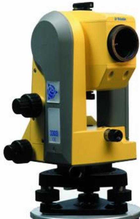
**Тахеометры Trimble серии 3300 выпускаются в модификации 3305 с 5-секундной точностью измерения углов и 3303 с 3-секундной точностью.**
