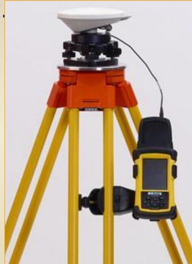
один приемник сигналов искусственных спутников Земли, электронный тахеометр и отражатели, закрепляемые на штативах и специальных вешках с уровнями.
