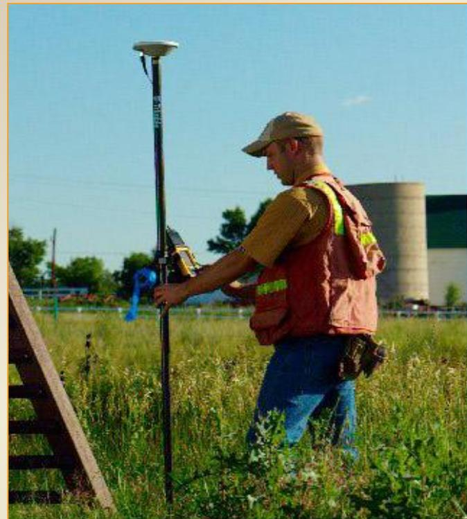
Параллельно с GPS-наблюдениями проводят измерения координат ряда граничных точек полярным методом с пунктов (съёмочных станций), положение которых определяется по технологии метода свободной станции.
