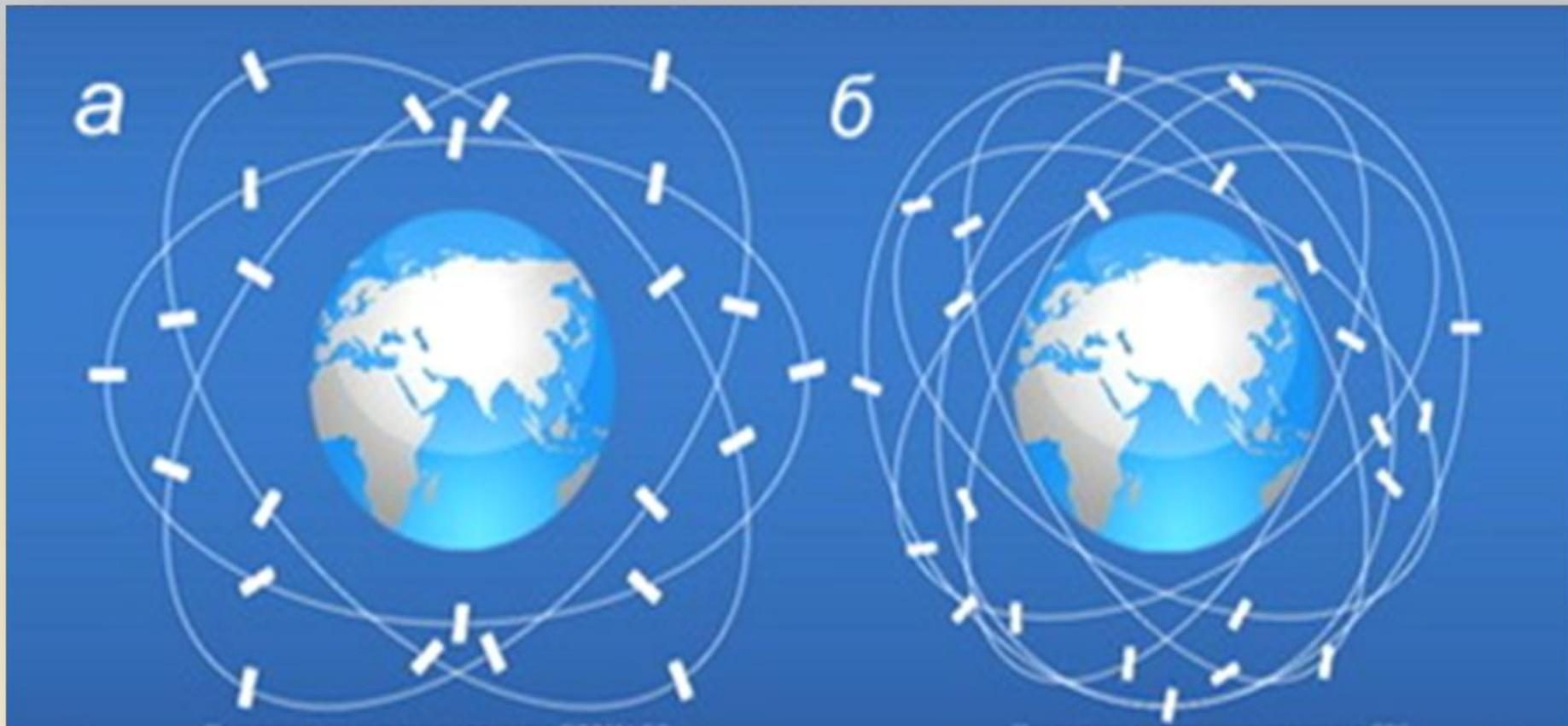
**а)** - ГЛОНАСС (3 орбиты по 8 спутников); **б)** - GPS (6 орбит по 4 спутника).
