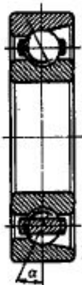
**2-6-307** — підшипник 1-го класу точності 6 із радіальною
