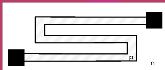
рис. 1.3. Зигзагообразная топология полупроводникового резистора.
