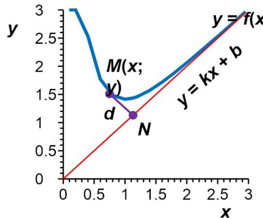
Итак, будем искать уравнение наклонной асимптоты к графику функции  $y = f(x)$  в виде  $y = kx + b$ . Найдем  $k$  и  $b$ .
