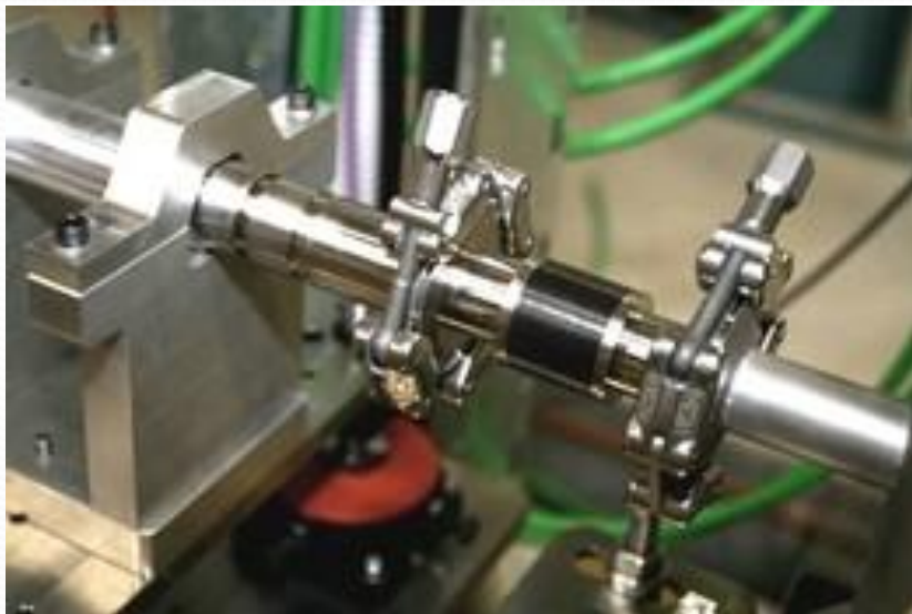
Гигавольтный синхротронный ускоритель. Звеньевые хомуты KF с быстро прижимными Al уплотнениями
