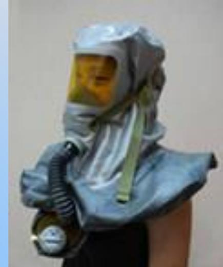
Гопкалитовый патрон ДП-1 предназначен для защиты органов дыхания от оксида углерода (угарного газа), его используют по назначению только с противогазом РШ-4.
