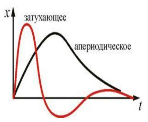
В случае апериодического движения энергия тела при возвращении в положение равновесия оказывается израсходованной на преодоление сил сопротивления, трения.
