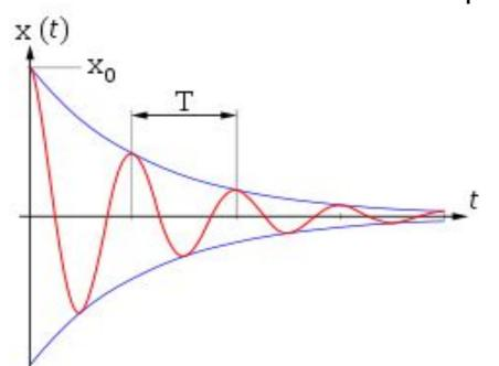
При увеличении силы трения  $\beta \to \omega_0$  и когда  $\beta = \omega_0$  движение становится апериодическим. Множитель перед косинусом  $x_0 e^{-\beta t}$  –
