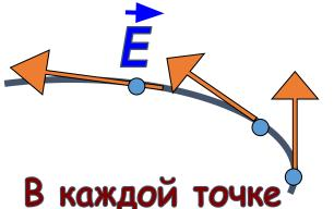
В каждой точке линии напряженности векторы силы направлены по касательной
