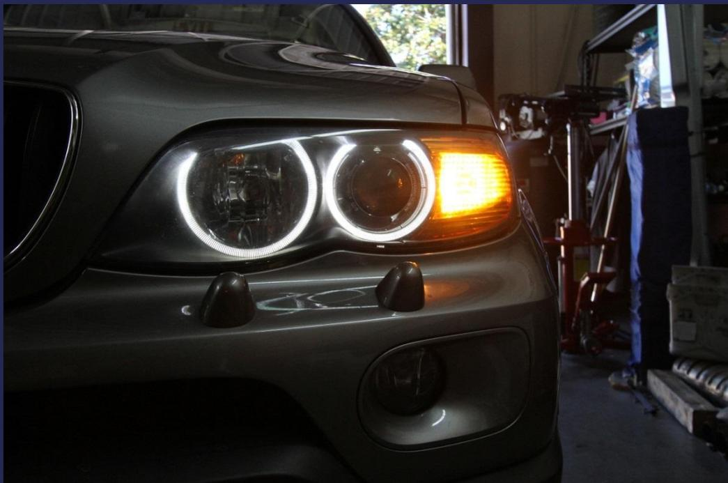
Габаритные огни (белые) служат для сигнализации спереди транспортного средства и его габаритной ширины (его установка обязательна на автомобилях и прицепах шириной более 1600 мм)
