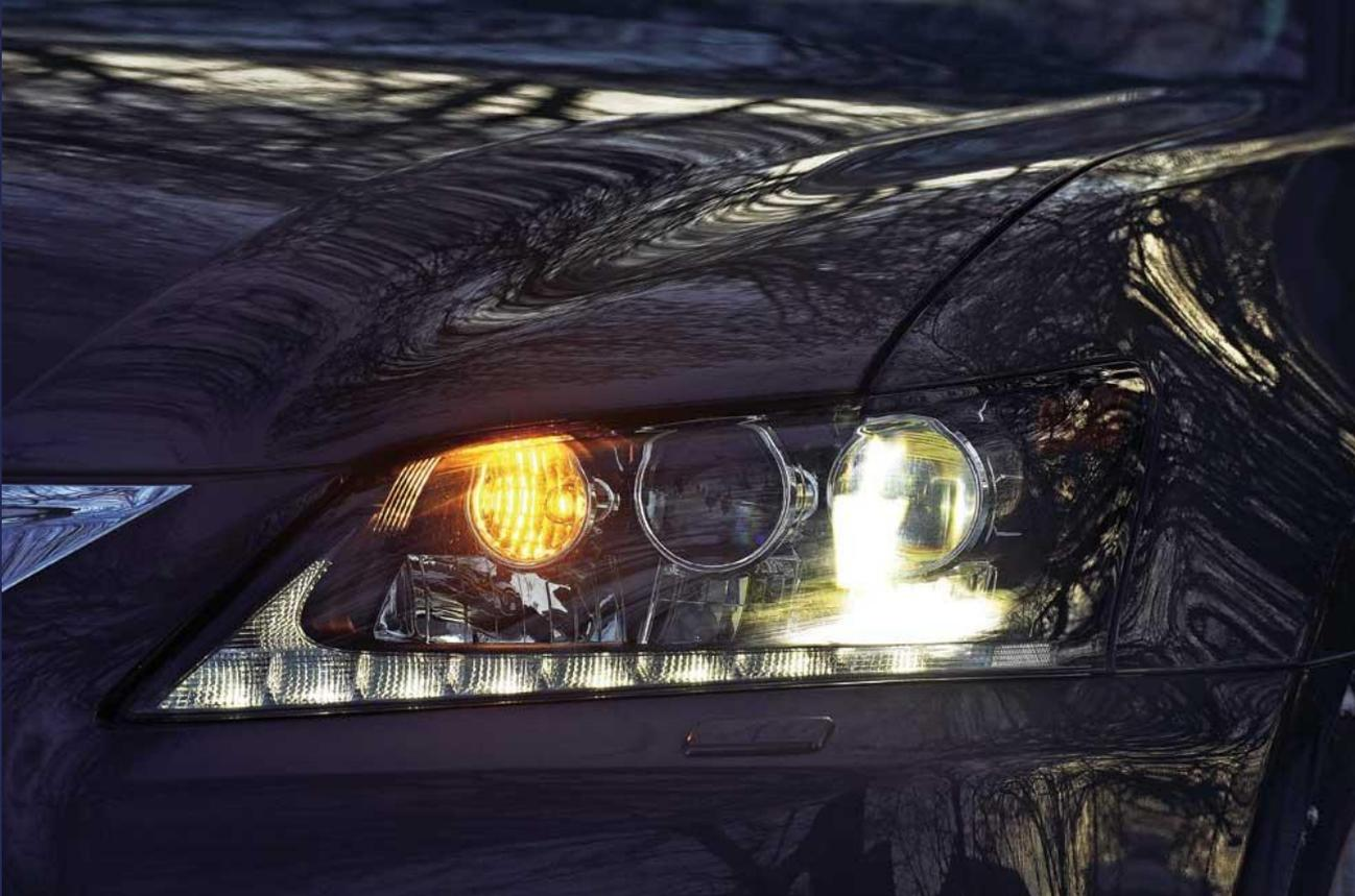
Указатель поворота (желтый) сигнализирует о намерении водителя повернуть вправо или влево. Огонь мигающий, часто совмещается с габаритным огнем, контрольный сигнал для водителя обязателен.
