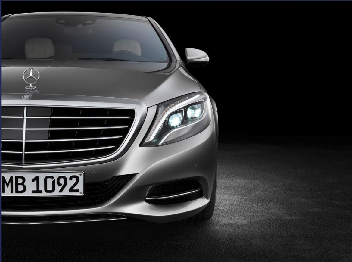
Могут комбинироваться с фарами ближнего света или устанавливаться отдельно, в любом случае - симметрично относительно продольной средней вертикальной плоскости транспортного средства. Обязательно наличие контрольного сигнала о включении фар дальнего света, обычно это индикатор синего цвета на панели приборов.
