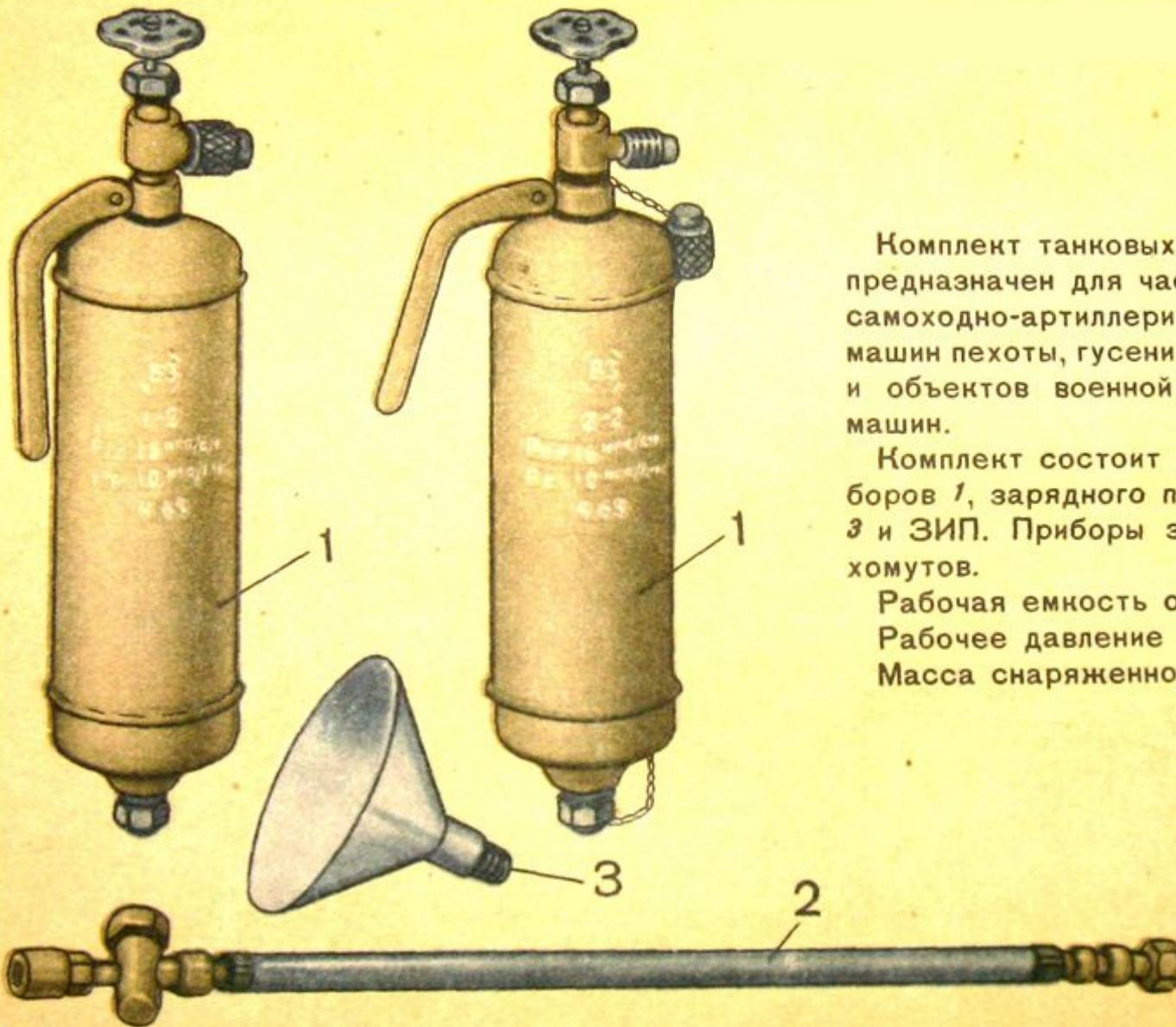
Комплект танковых дегазационных приборов предназначен для частичной дегазации танков, самоходно-артиллерийских установок, боевых машин пехоты, гусеничных бронетранспортеров и объектов военной техники на шасси этих машин.
