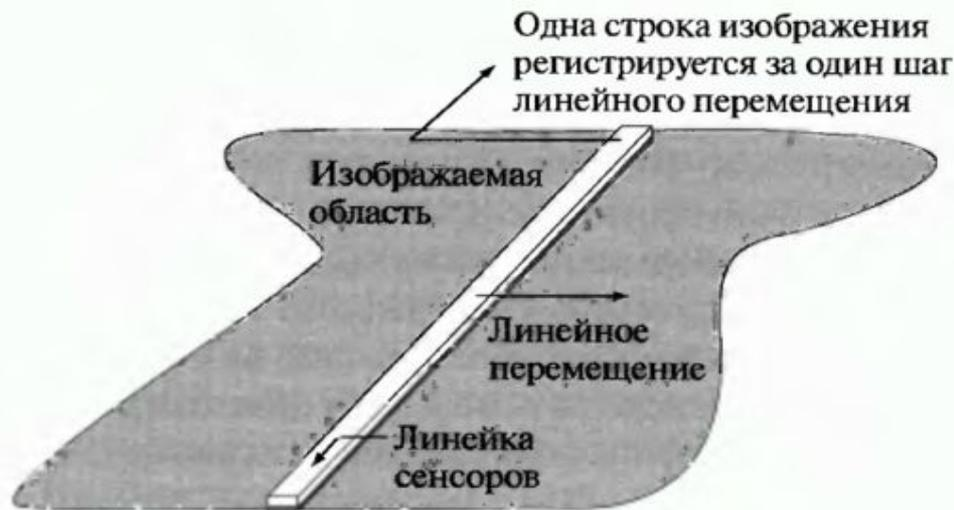
Линейка чувствительных элементов и считывание изображения с её помощью
