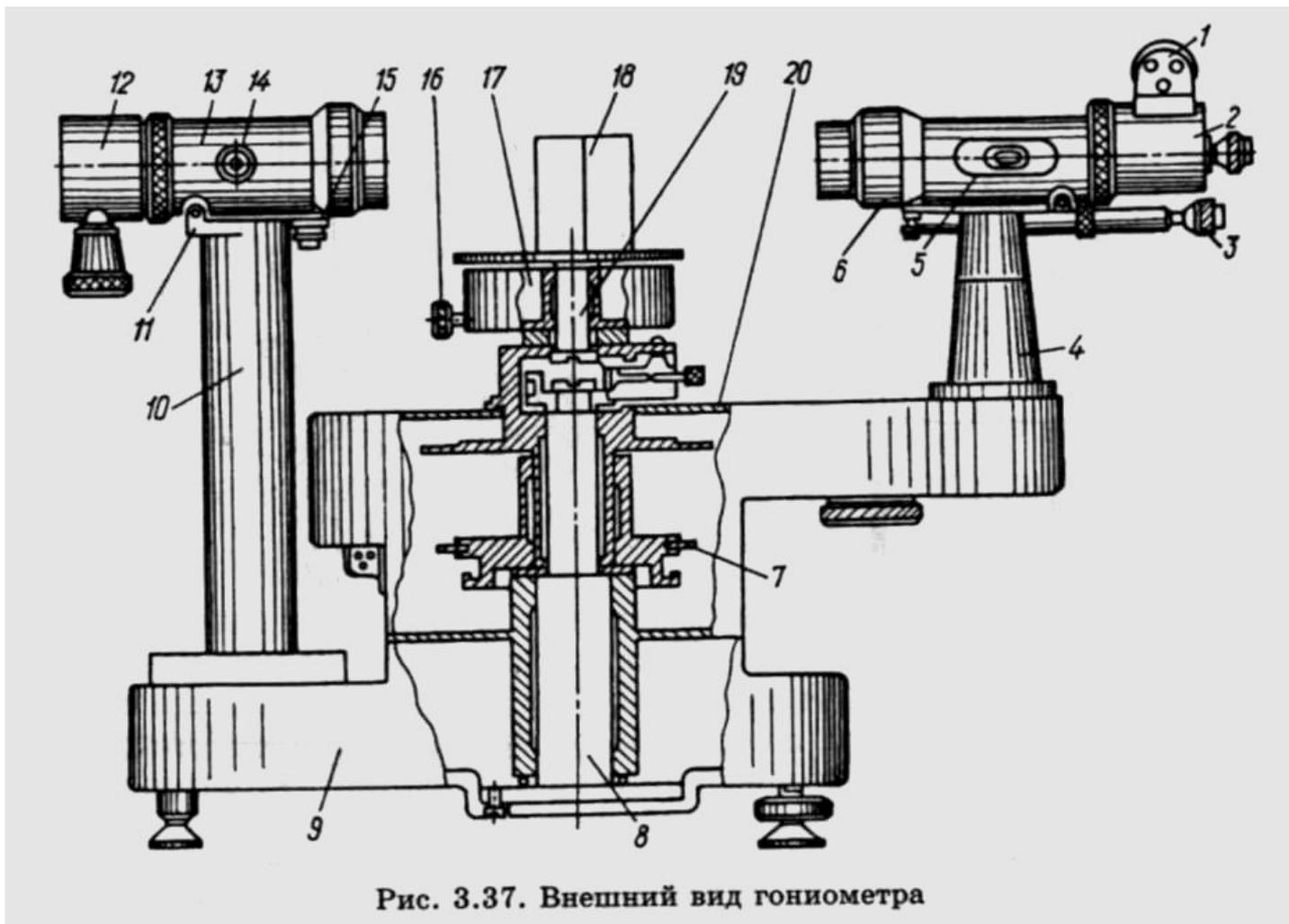
Рис. 3.37. Внешний вид гониометра
