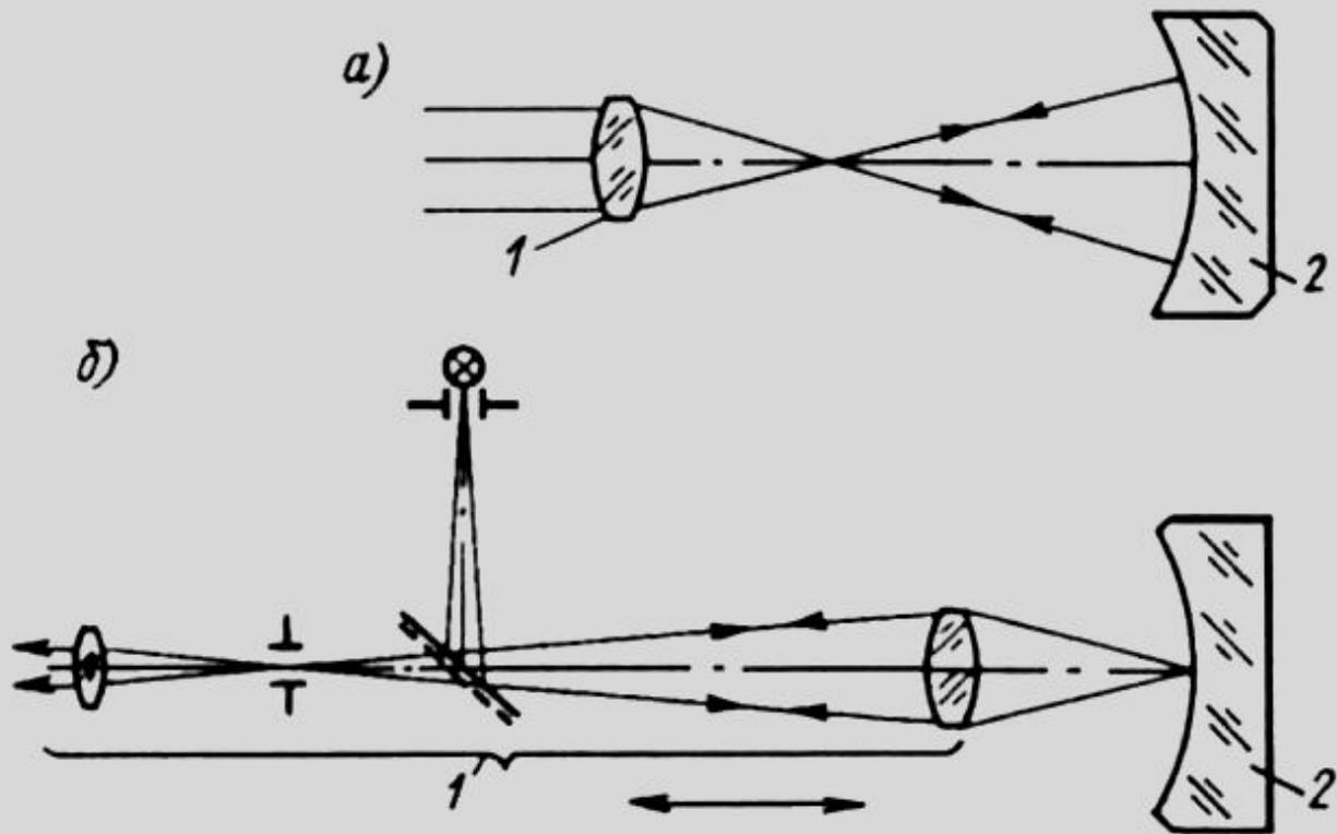
Рис. 3.9. Схема автоколлимационного метода измерения радиуса кривизны
