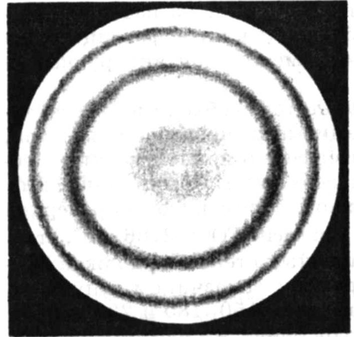
1 полоса (кольцо) – отклонение в  $\lambda/2$  ( $0,55 \text{ мкм} / 2 = 0,28 \text{ мкм}$ )
