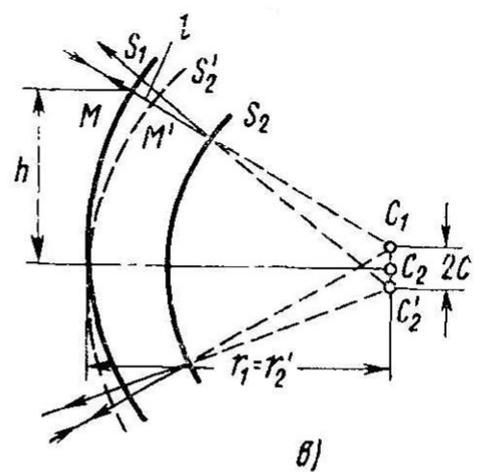
Автоколлимационные изображения светящегося отверстия  $A$  от эталонной поверхности мениска  $S_1$  и контролируемой поверхности линзы  $S_2$ :
