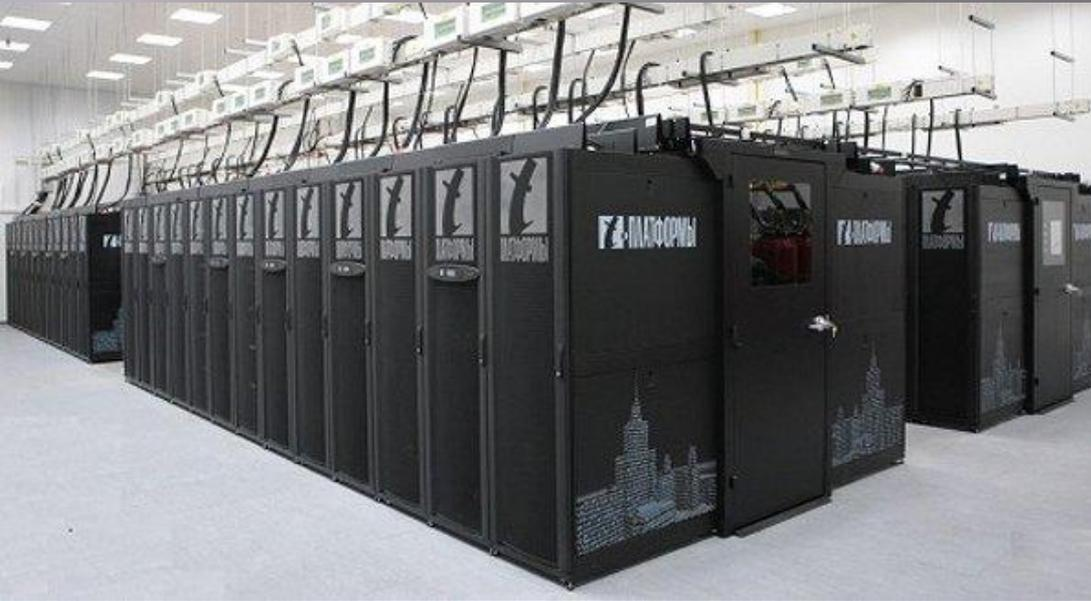
Суперкомпьютер «Ломоносов» - первый гибридный суперкомпьютер такого масштаба в России и Восточной Европе. В нем используется 3 вида вычислительных узлов и процессоры с различной архитектурой. Перед установкой в МГУ им. М.В. Ломоносова система прошла тщательное тестирование на производстве компании «Т-Платформы». В качестве основных узлов, обеспечивающих свыше 90% производительности системы, используется инновационная blade-платформа, получившая название T-Blade2
