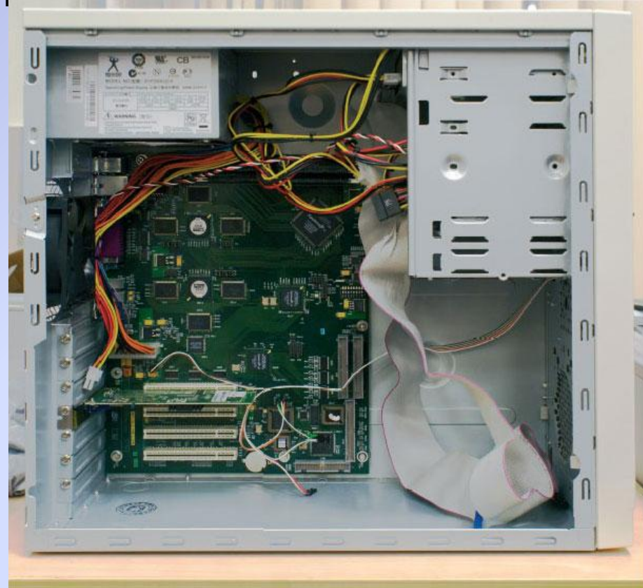
Эльбрус-90микро в конструктиве PC с периферийными шинами PCI и Mbus
