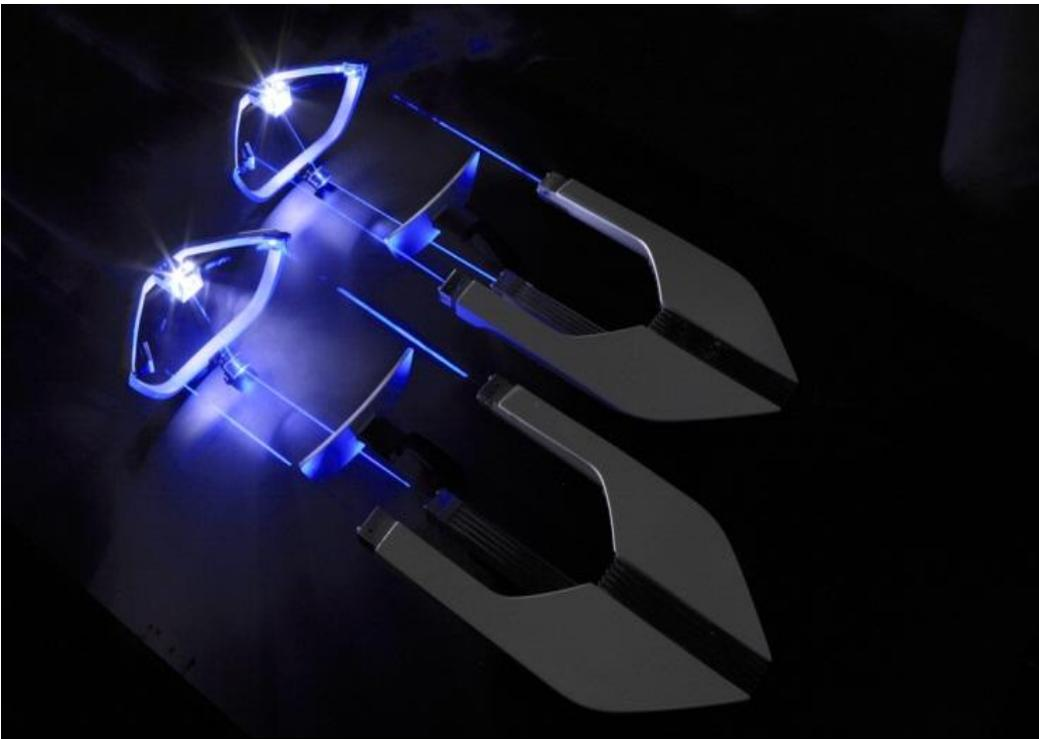
Die Laserdioden sind um das Zehnfache kleiner sind als konventionelle Leuchtdioden.
