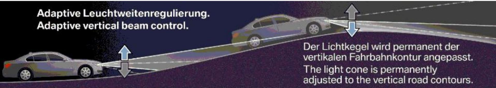
Der Lichtkegel wird permanent der vertikalen Fahrbahnkontur angepasst.
