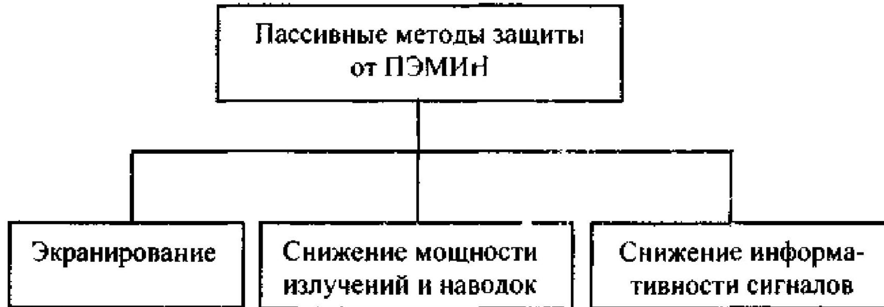
Экранирование является одним из самых эффективных методов защиты от электромагнитных излучений. Под *экранированием* понимается размещение элементов КС, создающих электрические, магнитные и электромагнитные поля, в пространственно замкнутых конструкциях.
