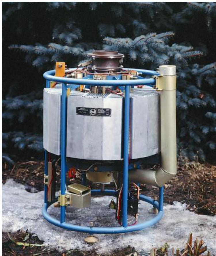
Пример ТЭГ Мощность 600 Вт для питания автономной сейсмической станции.
