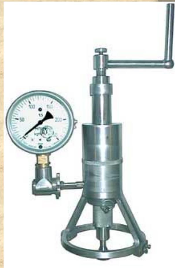
**Рис. 4.10. Пресс-насос ГПНВ-5 для вырыва анкерных устройств:**
