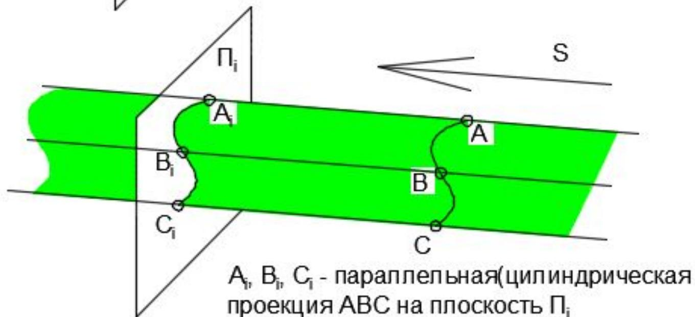
Если угол между  $S$  и  $\Pi_i = 90^\circ$  - проекция прямоугольная или ортогональная, если угол между  $S$  и  $\Pi_i \neq 90^\circ$  - проекция косоугольная
