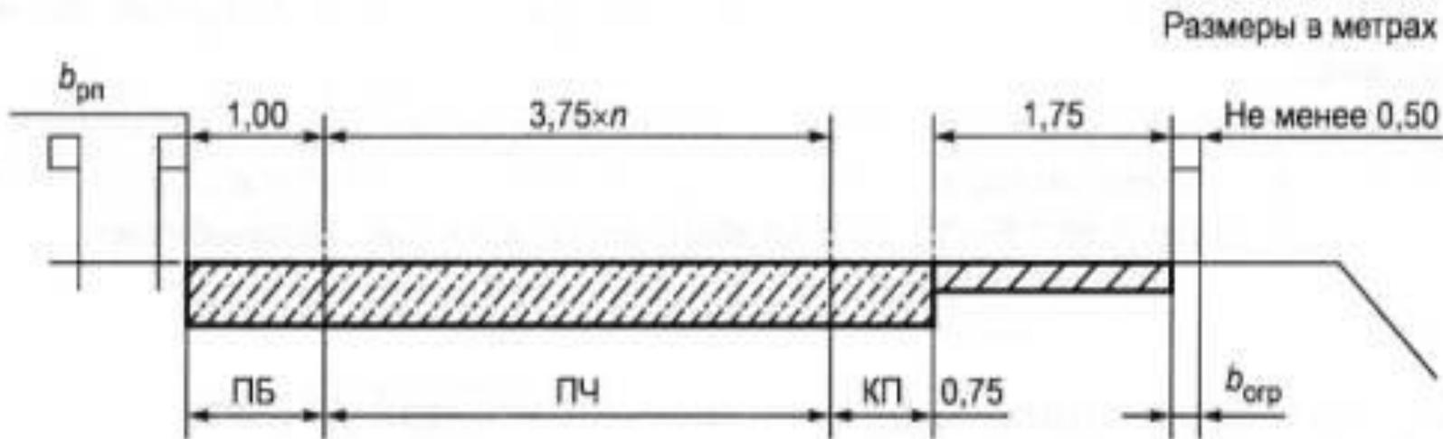
**ПБ** - краевая полоса у разделительной полосы, **ПЧ** - проезжая часть, **КП** - краевая полоса у обочины,  $b_{рп}$  - ширина разделительной полосы,  $b_{огр}$  - ширина ограждения с учетом требований [ГОСТ 23457](#)
