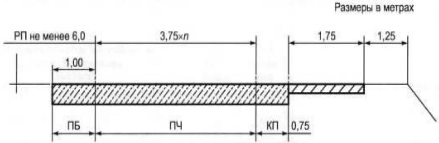
**ПБ** - краевая полоса у разделительной полосы, **ПЧ** - проезжая часть, **КП** - краевая полоса у обочины, **РП** - разделительная полоса
