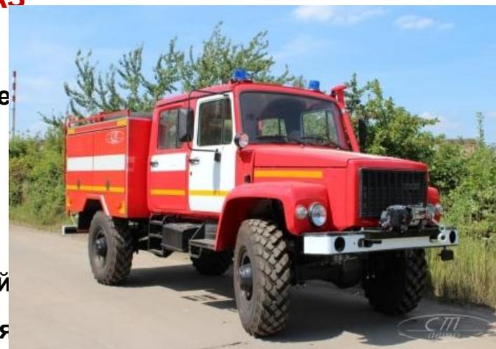
АЦ 2.2-40, 2.5-40, 3.0-40 (33086) с колёсной формулой 4x4. Небольшие габариты автомобиля ГАЗ-33086 – 6550x2910x2360 мм – обеспечивают лесопатрульной автоцистерне высокую проходимость, манёвренность в условиях бездорожья и лесистой местности. Автомобиль оснащён двухрядной пятиместной четырёхдверной кабиной. Оптимальное расположение дверей отсеков делает беспрепятственным и удобным подход к ПТВ. Емкость пенобака определяет заказчик.
