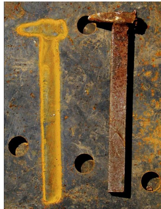
Поверхностная коррозия металлических элементов
