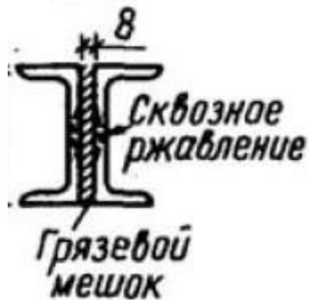
Щелевая коррозия металлических элементов
