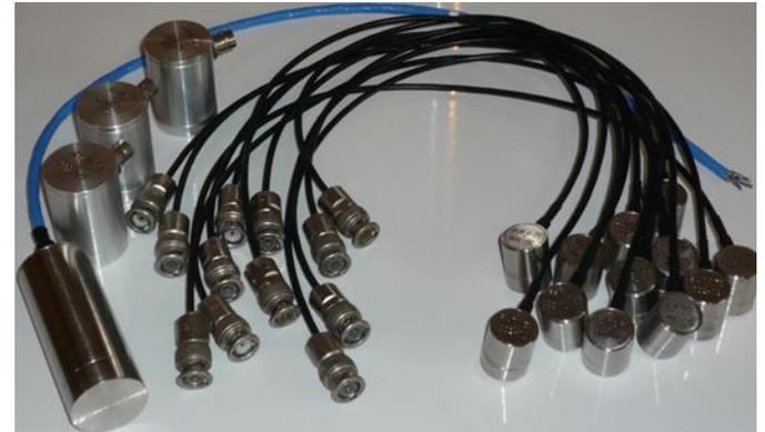
Типичная конструкция резонансного АЭ датчика
