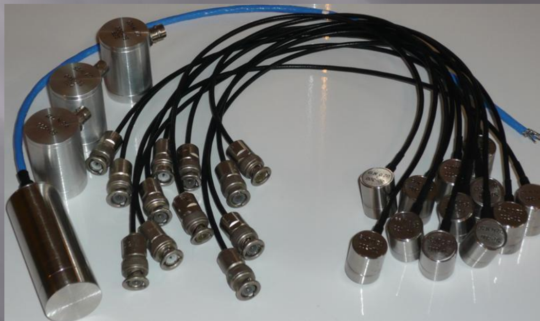
Рис. 4 - Многоканальная модульная АЭ-система семейства А-Line производства ООО "ИНТЕРЮНИС"
