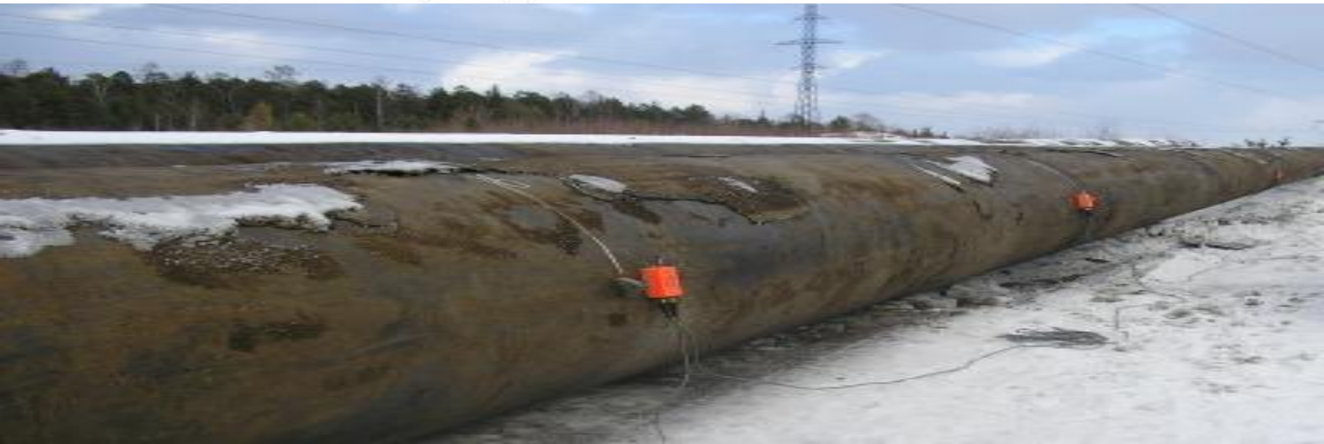
Рисунок 5 - Многоканальная модульная АЭ-система семейства А-Line производства ООО "ИНТЕРЮНИС"
