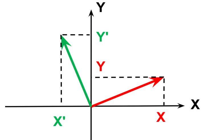
$$C_\varphi^z = \begin{bmatrix} \cos \varphi & -\sin \varphi & 0 \\ \sin \varphi & \cos \varphi & 0 \\ 0 & 0 & 1 \end{bmatrix}$$
