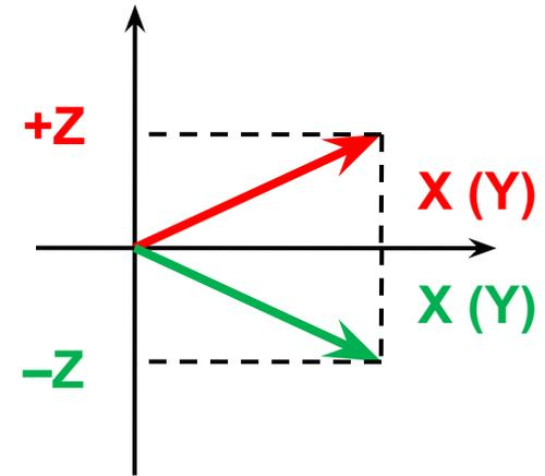
$$\begin{pmatrix} 1 & 0 & 0 \\ 0 & 1 & 0 \\ 0 & 0 & -1 \end{pmatrix} \cdot \begin{pmatrix} x \\ y \\ z \end{pmatrix} = \begin{pmatrix} x \\ y \\ -z \end{pmatrix}$$
