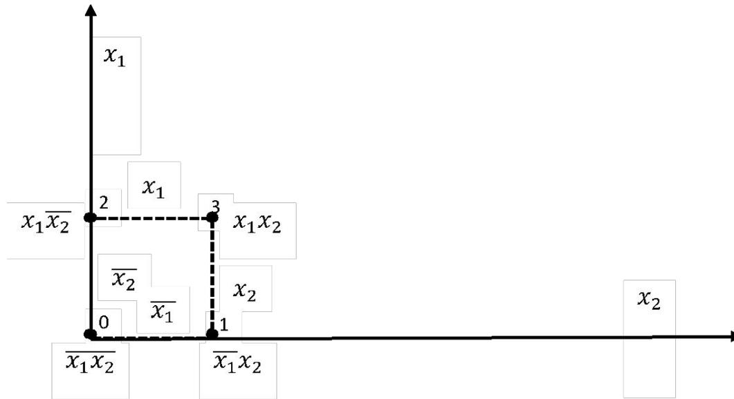
Две вершины, принадлежащие одному и тому же ребру, называются соседними и они «склеиваются» по переменной, изменяющейся вдоль этого ребра  $x_1x_2 \vee \overline{x_1x_2} = x_2(x_1 + \overline{x_1}) = x_2$
