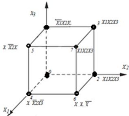
Булева функция отображается на  $n$ -мерном кубе путём выделения вершин, соответствующих векторам  $(x_1, x_2, \dots, x_n)$  на которых функция принимает значения «1». В геометрическом смысле каждый набор  $(\widetilde{x}_1, \widetilde{x}_2, \dots, \widetilde{x}_n)$ , т.е. каждая вершина может рассматриваться как  $n$ -мерный вектор, определяющий точку  $n$ -мерного пространства.
