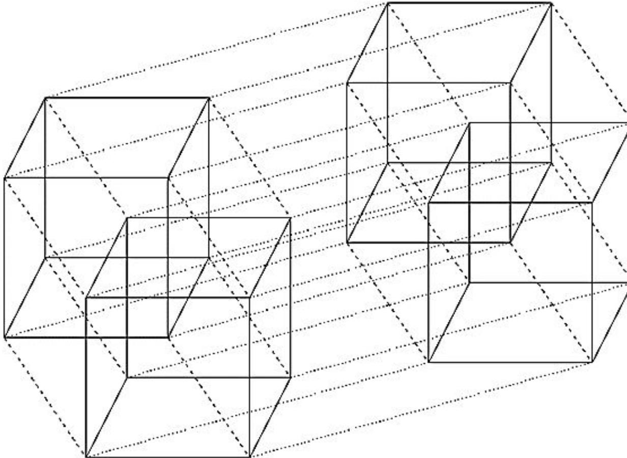
Минимизация булевой функции в геометрической форме.
