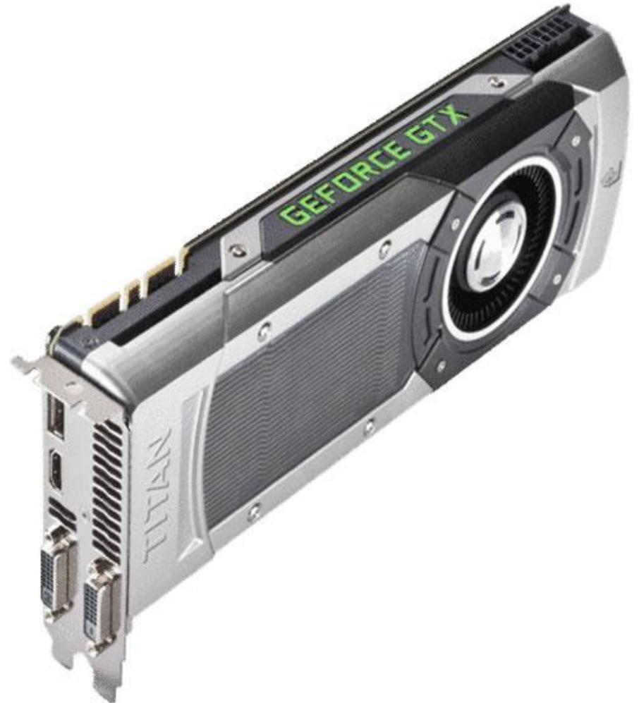
Обычно видеокарта является платой расширения и вставляется в специальный разъём для видеокарт на материнской плате, но бывает и интегрированной.
