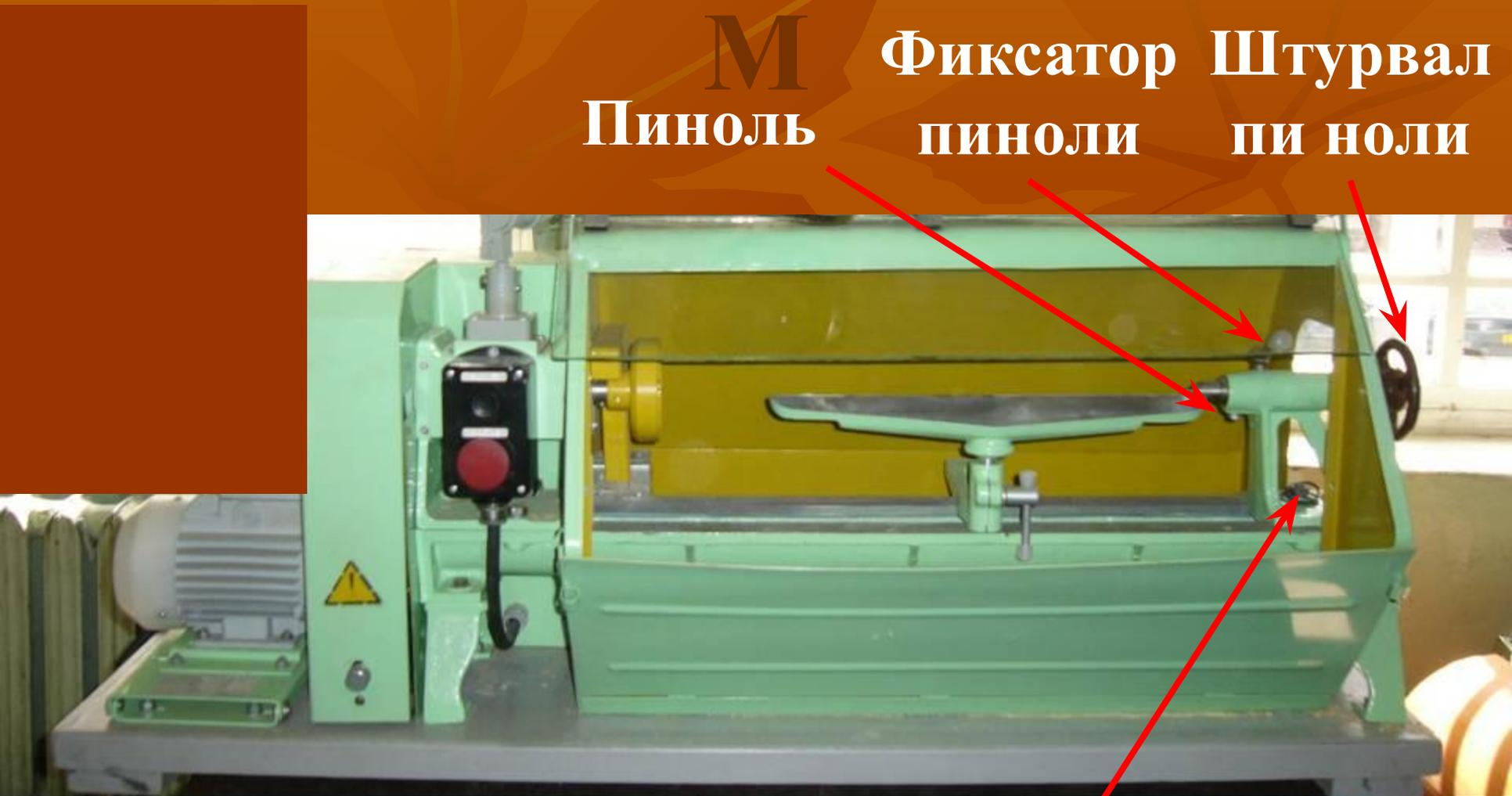
**Гайка фиксатор задней бабки**
