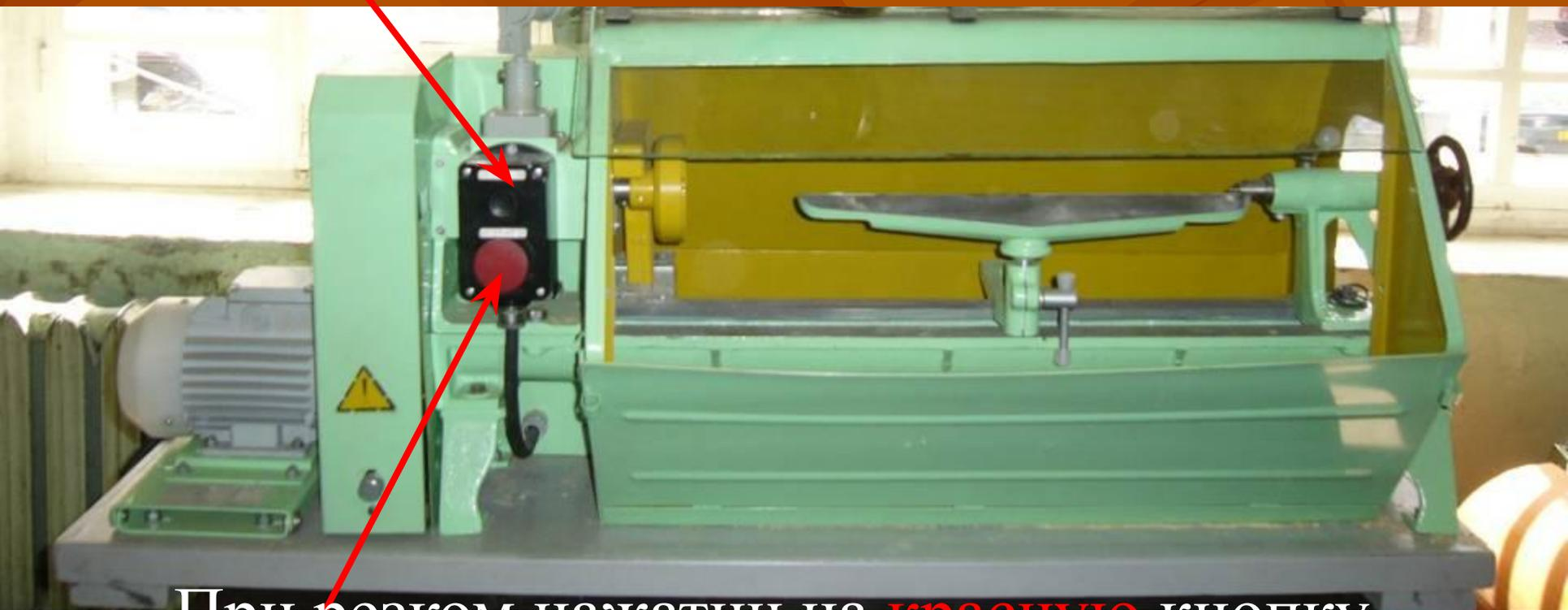
При резком нажатии на красную кнопку происходит аварийное отключение станка
