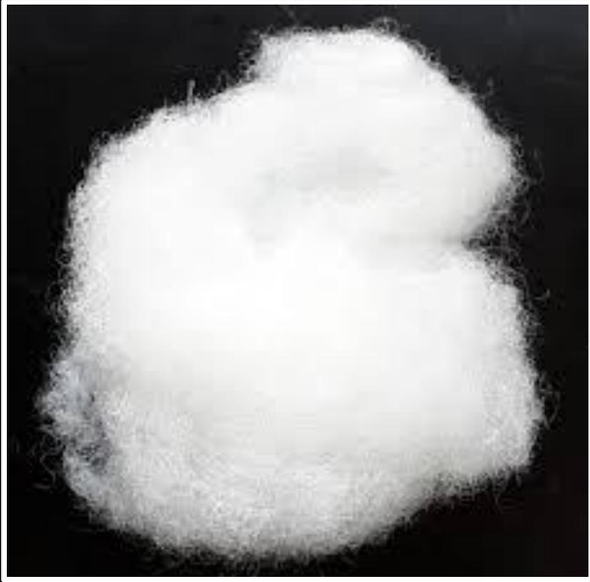
**Синтетический ватин** (синтепон, синтепух) – это легкий, объемный, упругий нетканый материал, в котором смесь полиэфирных волокон скрепляется иглопробивным или термическим способом.
