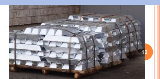
Олово — блестящий белый металл, обладающий низкой температурой плавления 231 °С и высокой пластичностью. Применяется в составе припоев, медных сплавов (бронза) и антифрикционных сплавов (баббит).
