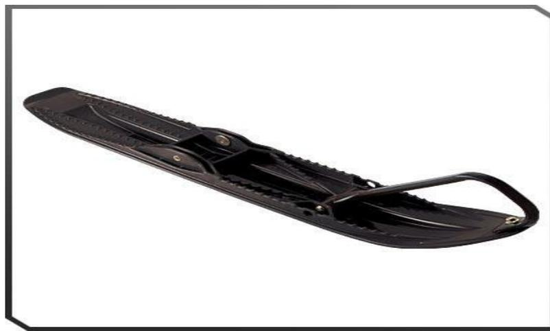
• «Конек» представляет собой металлический прут с победитовой напайкой. «Конек» крепится на болтовом соединении и может легко меняться. Именно «конек» обеспечивает управляемость на плотных покрытиях, на льду. Он же защищает лыжу при переезде дорог и препятствий. Как показывает практика, переезд на снегоходе через автомобильную дорогу является нормальным и не вызывает существенного износа «коньков».
