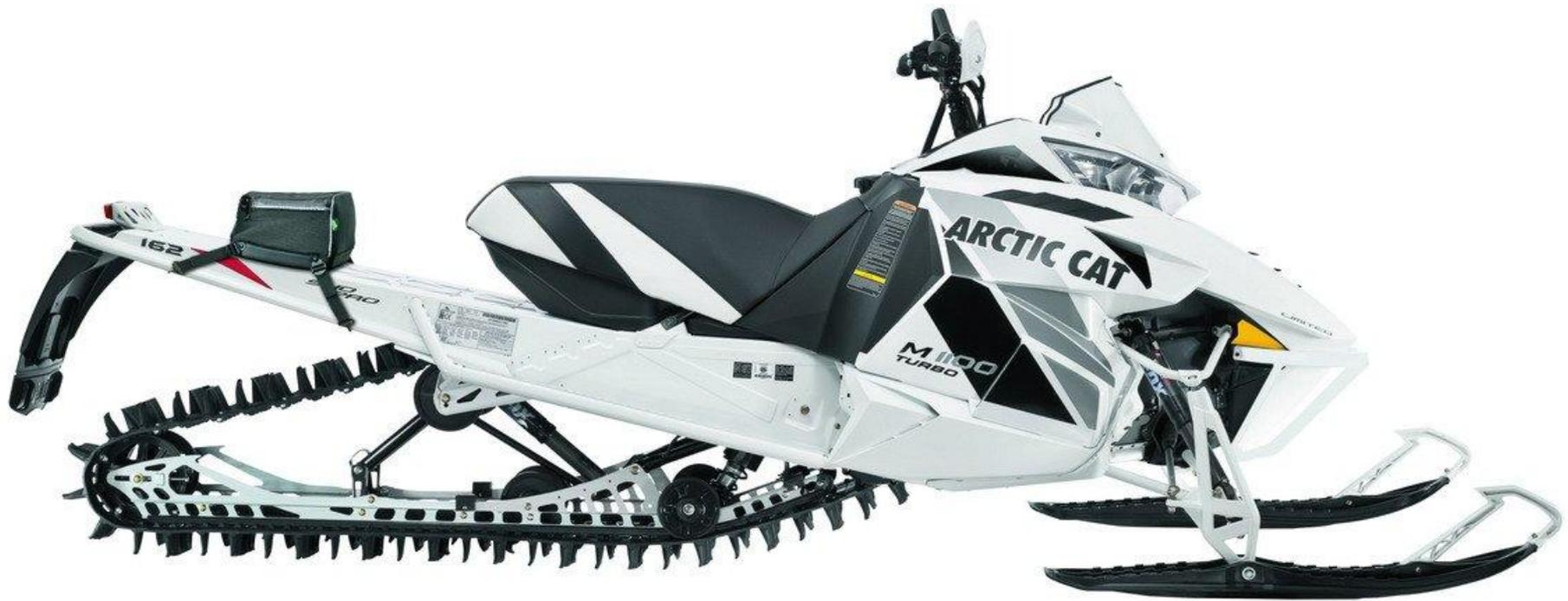
Модели со спортивными динамическими характеристиками и усиленной длинноходной подвеской. Обладают характерными высотой гусеницы и профилем трака. Внешне эти машины можно отличить по удлинённому силуэту в паре с удлинённой гусеницей - это сделано для устойчивости при движении круто вверх, в гору.
