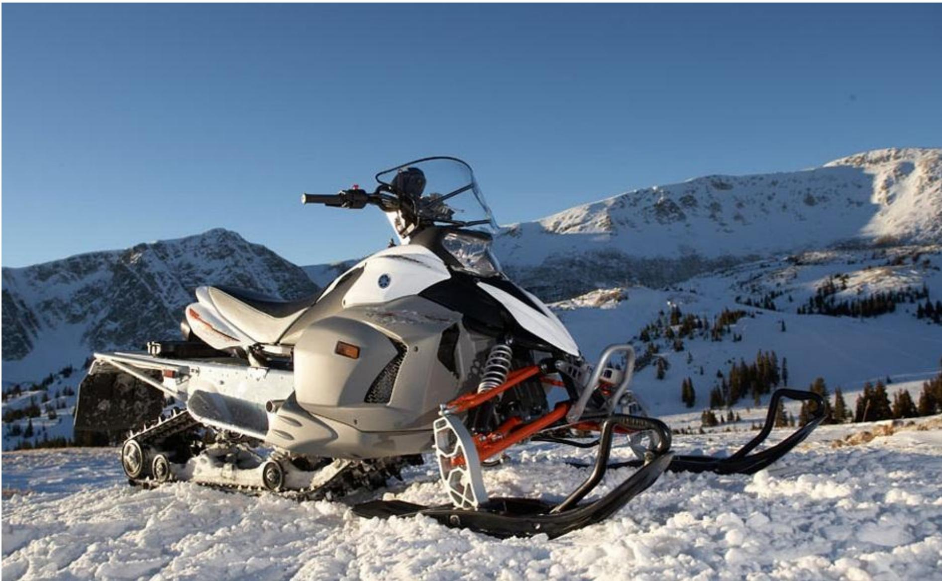
Подавляющее большая часть снегоходов сегодня изготовлено по схеме «две лыжи впереди/одна гусеница сзади». При такой схеме снегоход опирается на три точки, расположенные треугольником. Прежде всего такая схема обладает оптимальной устойчивостью.
