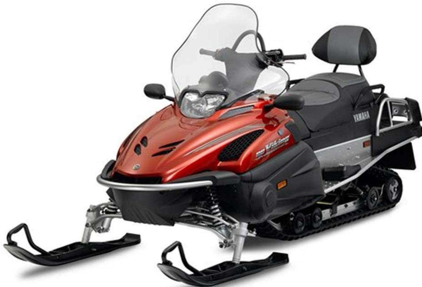
Многоцелевые машины с повышенной проходимостью и грузоподъемностью, идеально подходящие для работы. Снегоходы утилитарного (рабочего) типа имеют расширенную базу и широкую гусеницу, благодаря которой не проваливаются в глубокий снег. "Утилитарники" оснащаются тяговитым двигателем и трансмиссией, в которой можно включить понижающую передачу для буксировки тяжелого груза или подъема на крутые горные склоны.
