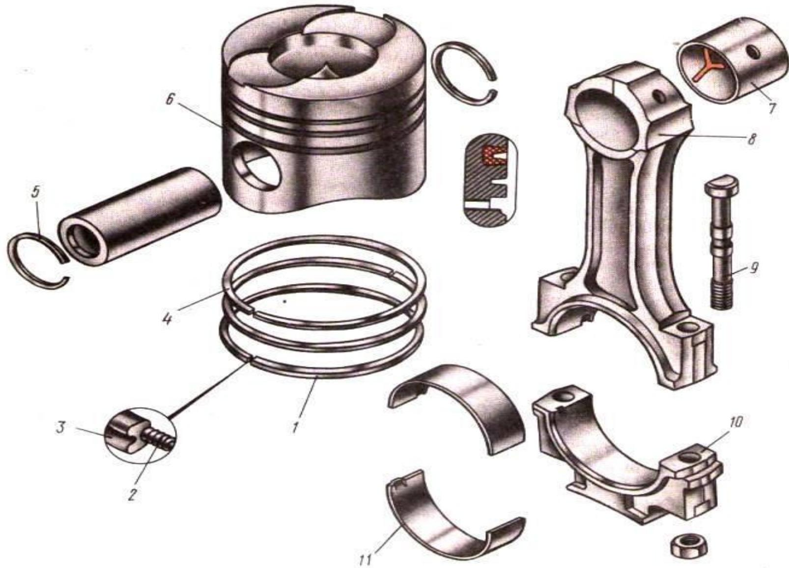
Поршень с шатуном: 1 — маслоъемное кольцо в сборе, 2 — витой пружинный расширитель, 3 — чугунное кольцо, 4 — компрессионное кольцо, 5 — стопорное кольцо поршневого пальца, 6 — поршень, 7 — втулка шатуна, 8 — шатун, 9 — болт крепления крышки шатуна, 10 — крышка шатунного подшипника, 11 — вкладыш нижней головки шатуна.
