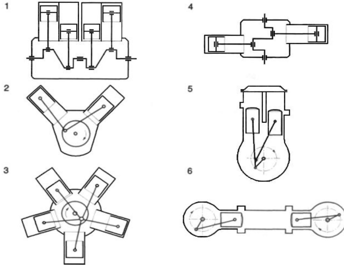
**Рис. 2.4. Расположение цилиндров двигателя.**
