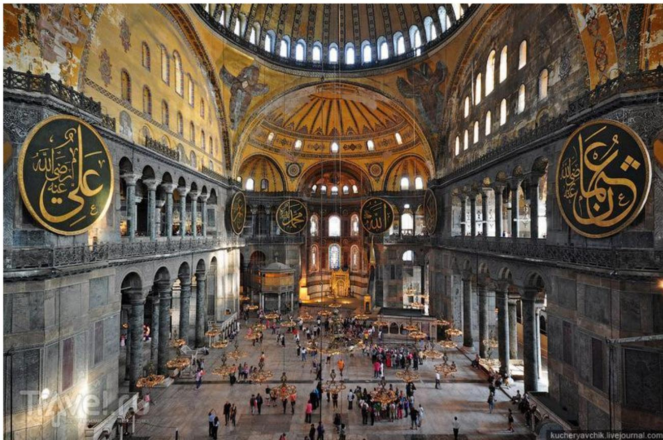
В продольном направлении распор от купола погашается системой полукуполов, в поперечном - мощными контрфорсами и двухъярусными боковыми нефами.
