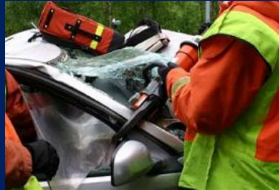
2. Отрезать обе передние стойки
