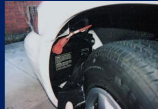
Расположение аккумулятора в арке переднего колеса
