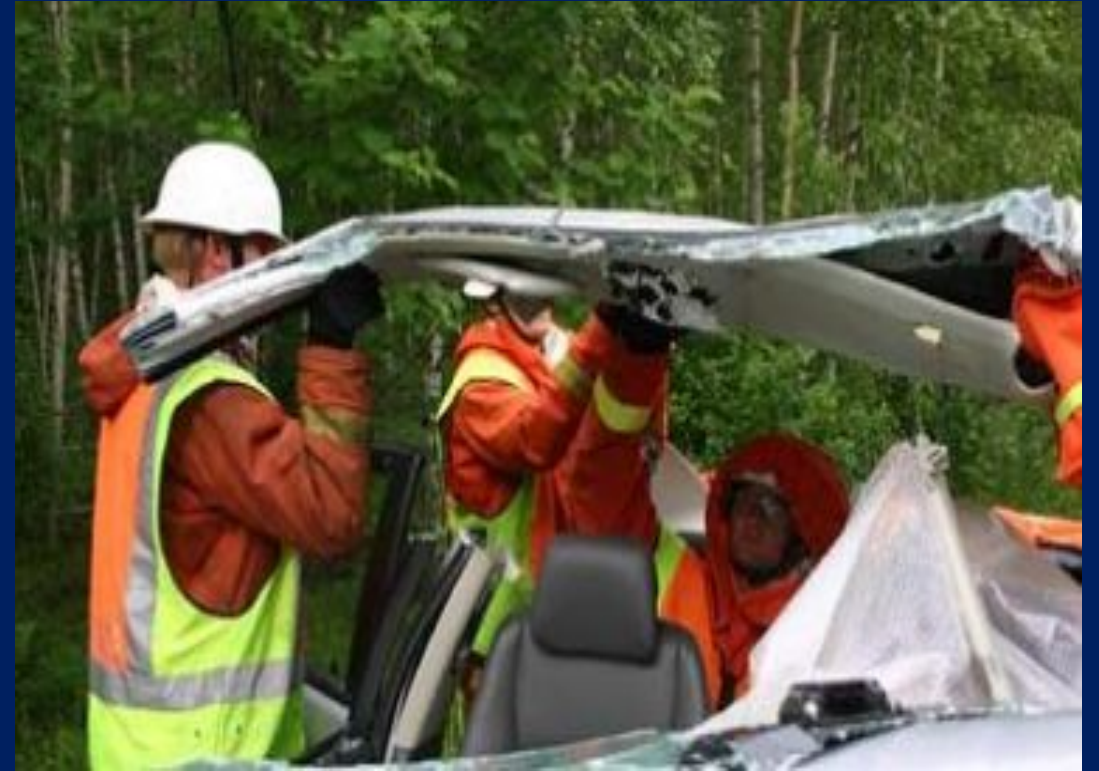
7. Убедившись, что отсутствуют любые другие соединительные точки и связи, такие как ремни безопасности или детали пластиковой отделки, можно снять крышу с автомобиля и перенести ее на специально выделенную для этой цели площадку.
