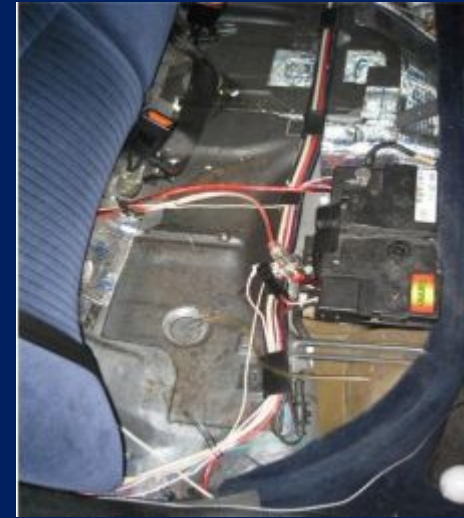
Расположение аккумулятора под задним пассажирским сиденьем
