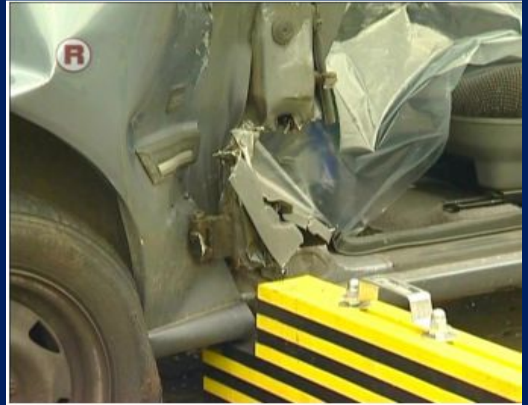
3. Отогнуть эту секцию наружу с помощью расширителя.
