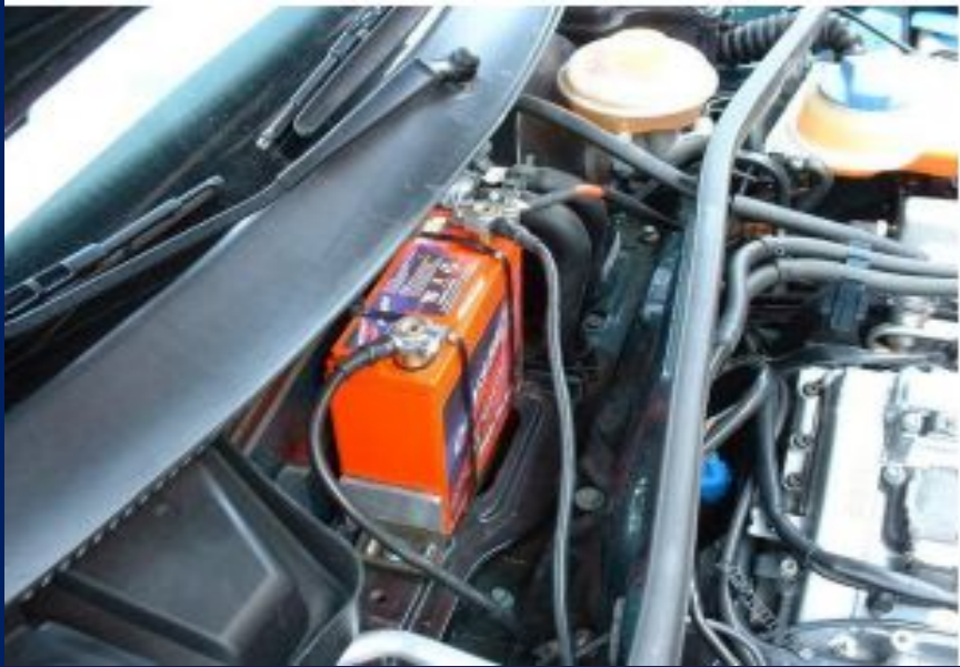
Расположение аккумулятора в подкапотном пространстве со стороны «торпедо»
