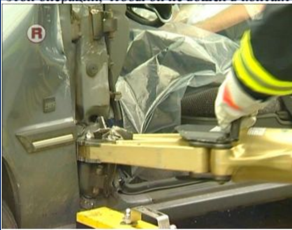
2. Зажать расширителем вырезанный кусок секции.
