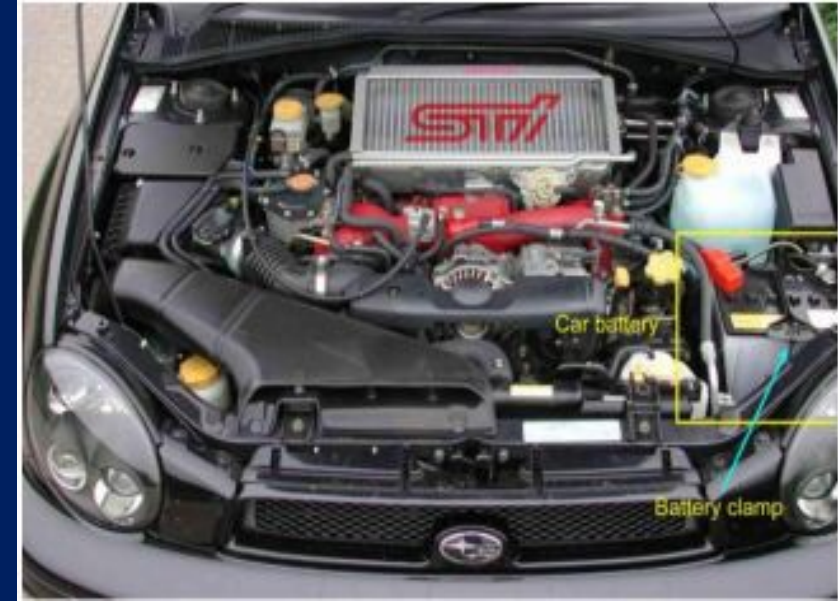
Расположение аккумулятора в передней части подкапотного пространства сбоку за радиатором
