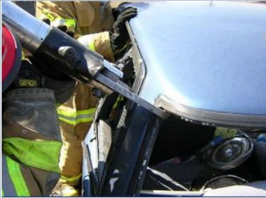
6. Отрезать задние стойки
