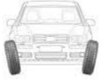
Наклон от кузова положительный развал колес
