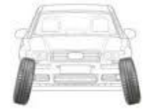
Наклон к кузову отрицательный развал колес
