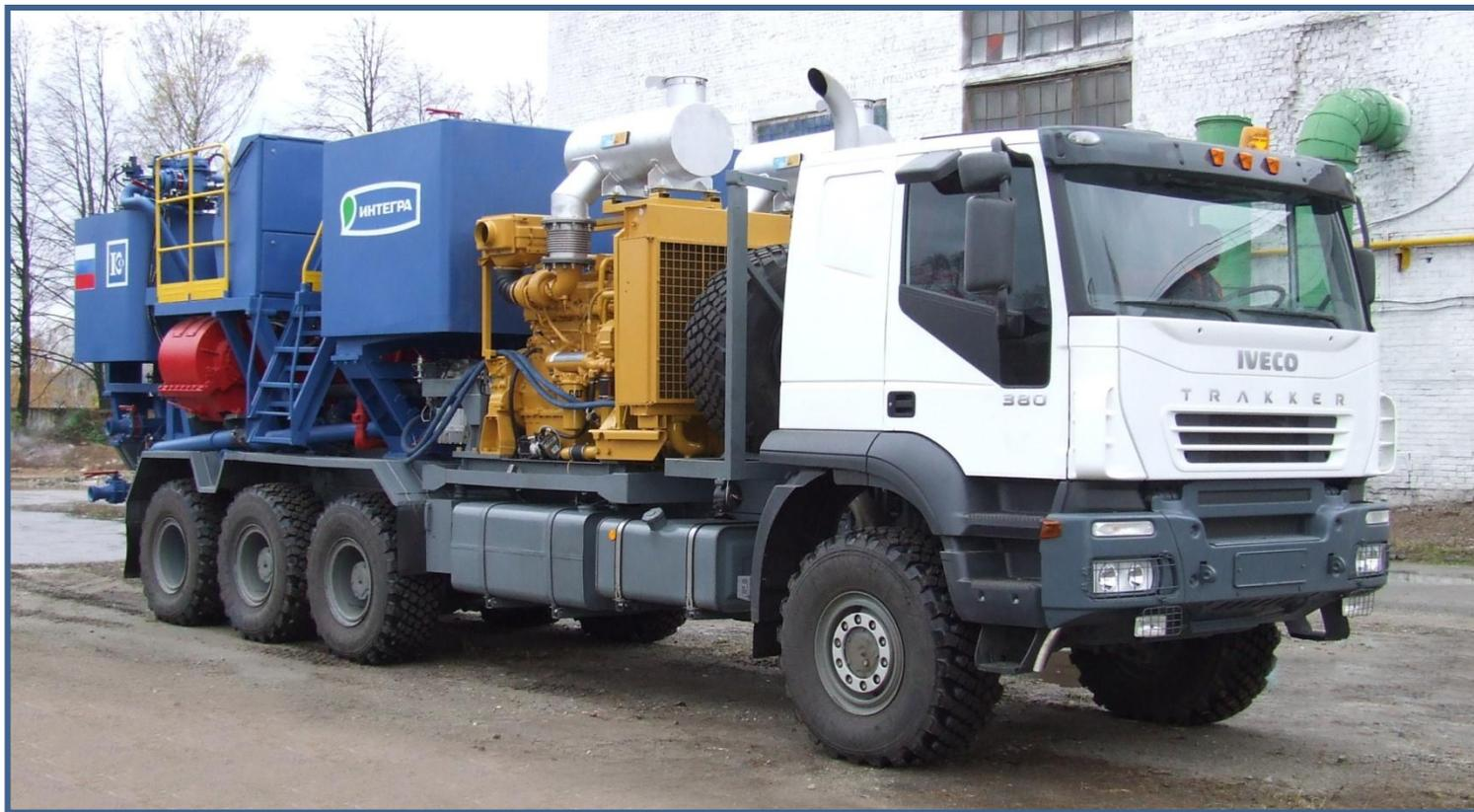
Установка предназначена для нагнетания тампонажных растворов и технологических неагрессивных жидкостей в нефтяные и газовые скважины при цементировании, проведения промывочно-продавочных работ при освоении и капитальном ремонте нефтяных и газовых скважин.
