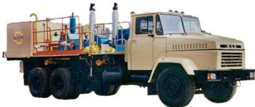
Предназначен для закачки и продавки цементного раствора в скважину. Состоит из поршневого или плунжерного насоса высокого давления с приводом от двигателя автомобиля, двух мерных баков и системы обвязки. Управление механизмами агрегата ведется с единого поста, расположенного на платформе машины. Мерные баки агрегата служат для измерения объема продавочной жидкости. Имеется центробежный водяной насос для затворения цемента.
