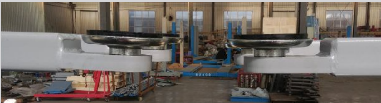
Контроль Плоскости подхватов (говорит о точности сварки)
