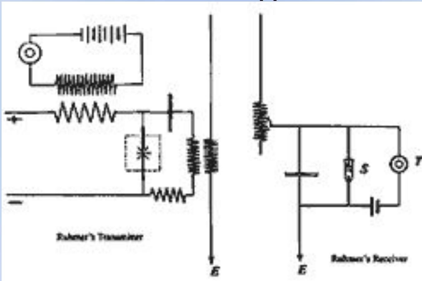
В 1906 году Румер предложил свою систему беспроволочной телефонии с использованием дугового передатчика и электролитического детекторного приемника. В передатчике была использована дуговая лампа постоянного тока в водородной атмосфере. В лабораторных экспериментах в качестве антенны применялся вертикальный провод длиной 1,5 м — с такой антенной передатчик позволял передать речь на расстояние 30 метров .
