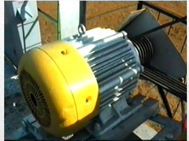
Электродвигатель на поворотных салазках, ведущий шкив ременной передачи
