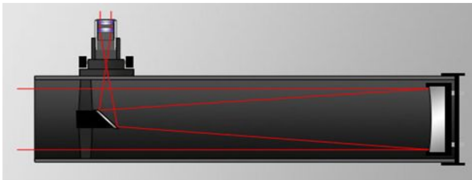
Зеркально-линзовый телескоп системы Ньютона
