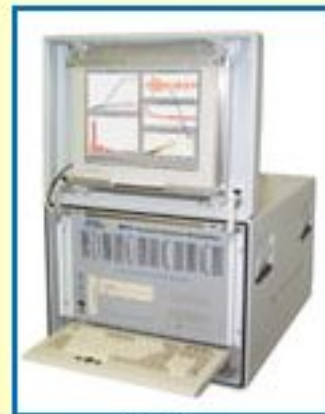
Система DiSP-56 в прочном пылевлагозащищённом корпусе
