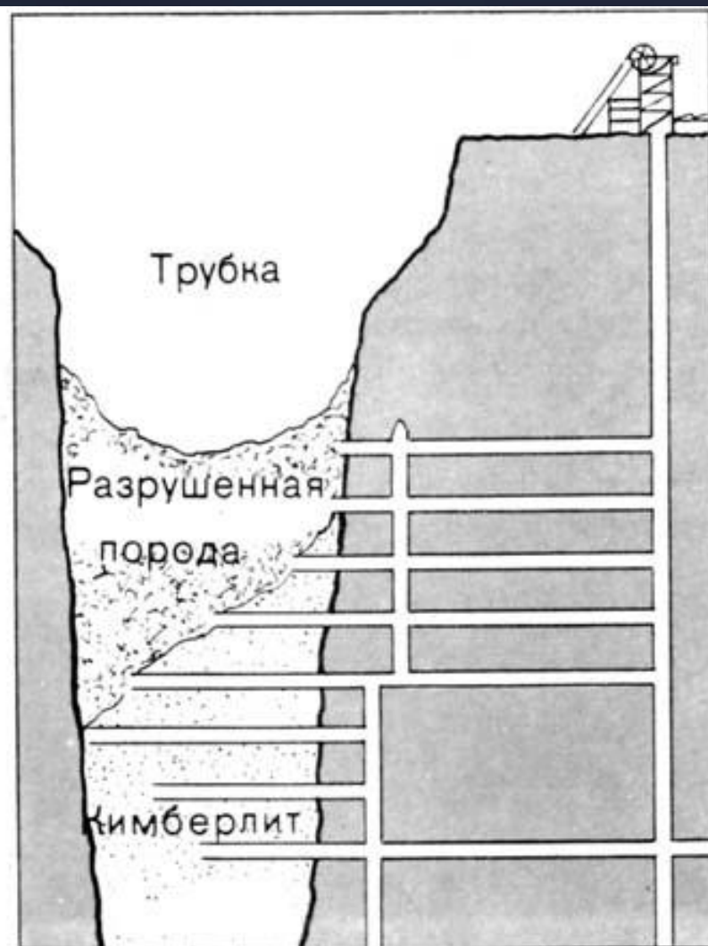
Подземная разработка месторождения в кимберлитовой трубке.
