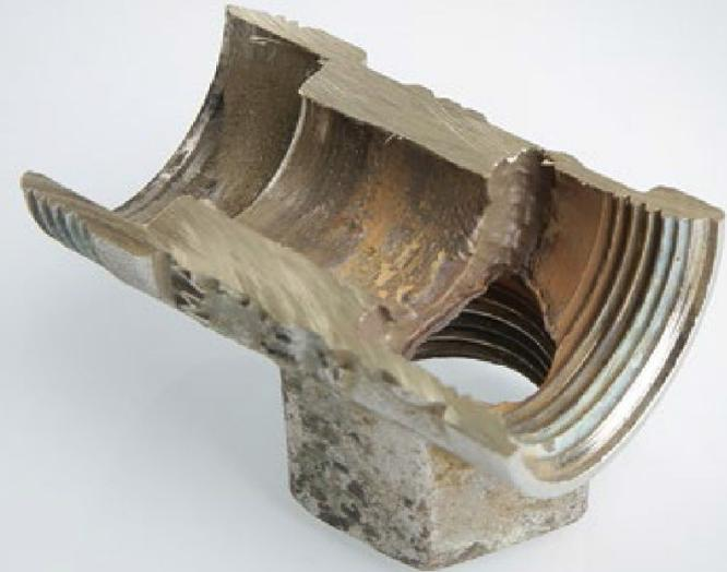
*Когда в золотниковом узле редуктора происходит слишком большое дросселирование потока, он начинает шуметь, а в призолотниковой зоне может происходить абразивно-кавитационное разрушение седла и корпуса.*
