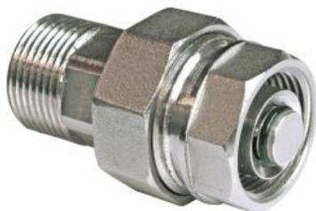
Сгон-отсекатель предназначен для разделения внутреннего трубопровода здания или сооружения на ремонтные участки без опорожнения системы в целом. Основное назначение изделия - установка на трубопроводе, присоединяющем расширительный бак системы отопления или ГВС. Установка на этом трубопроводе обычной запорной арматуры нормативно запрещена. Сгон-отсекатель дает возможность отключать расширительный бак на период проведения гидравлических испытаний, производить его ремонт или замену.
