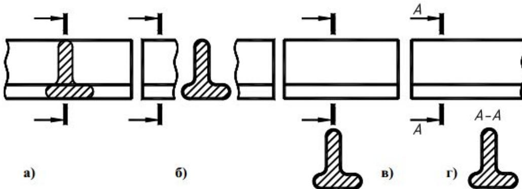
Сечения также подразделяют на **наложенные** (рис. а), расположенные в разрыве вида (рис. б), и **вынесенные** (рис. в, г)
