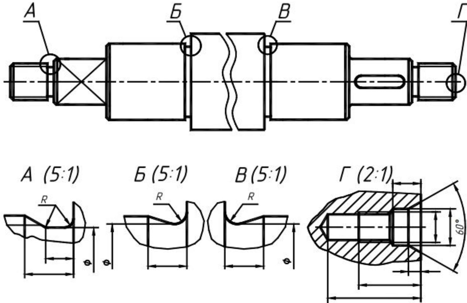
**Выносной элемент** – дополнительное отдельное изображение (обычно увеличенное) какой-либо части предмета, требующей графического и других пояснений в отношении формы, размеров и иных данных.
