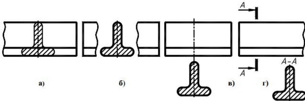
Сечения, не входящие в состав разреза, разделяют по форме на **симметричные** и **несимметричные**.
